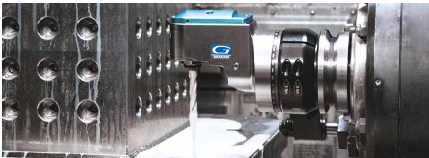
Testa angolare FR90-10B 70bar in lavorazione - Angle heads FR90-10B 70bar during works
