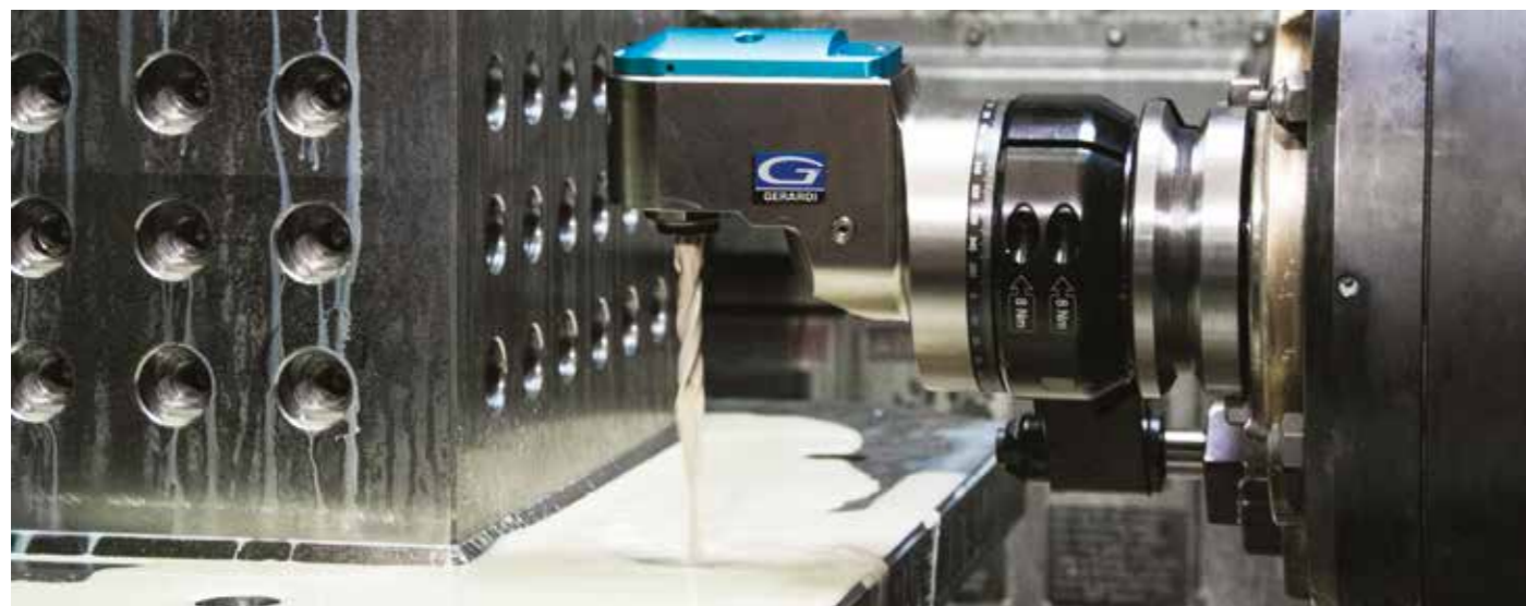
Testa angolare FR90-10B 70bar in lavorazione - Angle heads FR90-10B 70bar during works
