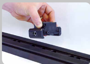
2 Abheben und neu platzieren Lift and change position
